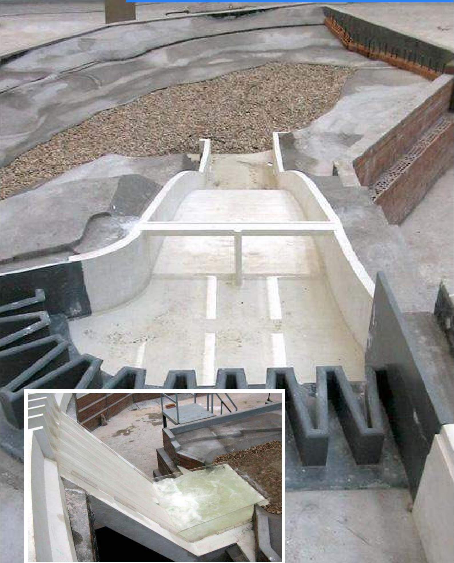
Modelo reducido de la presa de Montearagón
